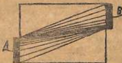
Fig. 5— Electrodoos parallelos, de igual tamanho porem não se correspondem. O calor se concentra nas extremidades mais approximadas, nos vertices das pyramides A e B.
